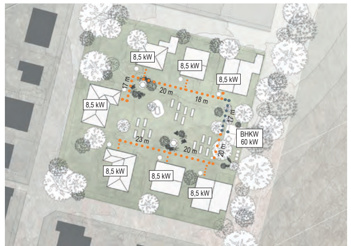
Gebäudeverband mit Mini-BHKW
